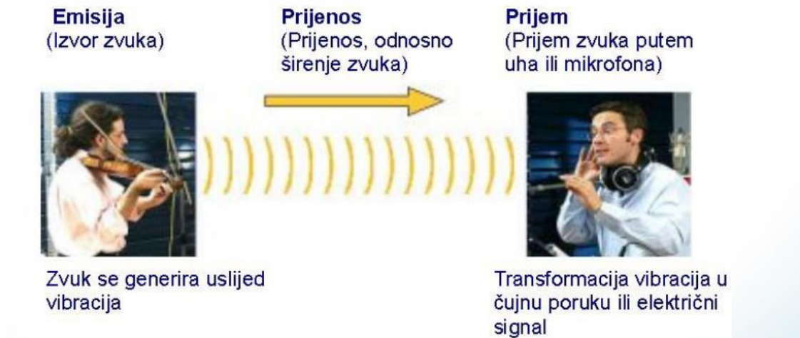
Slika 1 Prikaz osnove akustičkog sustava
