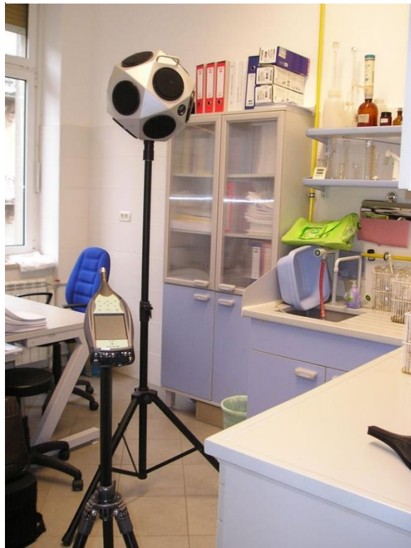
Slika 6. Zvučnik i zvukomjer, NZZJZIŽ Pula
