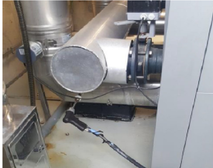
Slika 18. Sonda umetnuta u ispust
