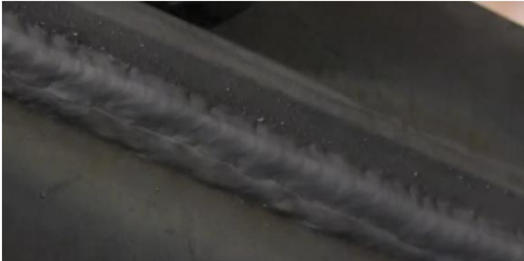
Sl.18 Slika drugog uspješno obavljenog nanosa zavarivanja MIG metodom iznad glave, izvor: https://www.youtube.com/watch?v=uvjZNTqi_aU&t=2s (17.9.2024)
