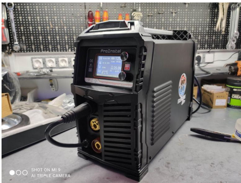
Sl.13 slika pulsnog aparata koji se koristi za prijenos metala pomoću električne struje, izvor: https://proinstal.hr/shop/aparati-zavarivanje-varenje/mig-mag-fcaw-co2/dupli-pulsni-co2-aparat-za-varenje-mig-tig-mma-200a/ (17.9.2024)
