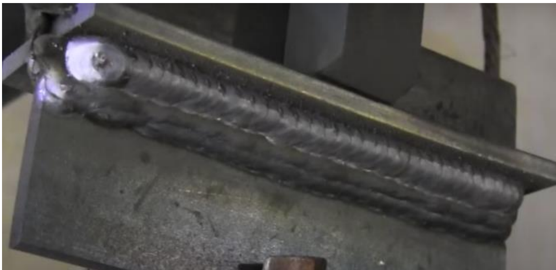
Sl.20 Slika uspješnih pet nanosa na kutnom spoju korištenjem MIG metode zavarivanja iznad glave, izvor: https://www.youtube.com/watch?v=uvjZNTqi_aU&t=2s (17.9.2024)
