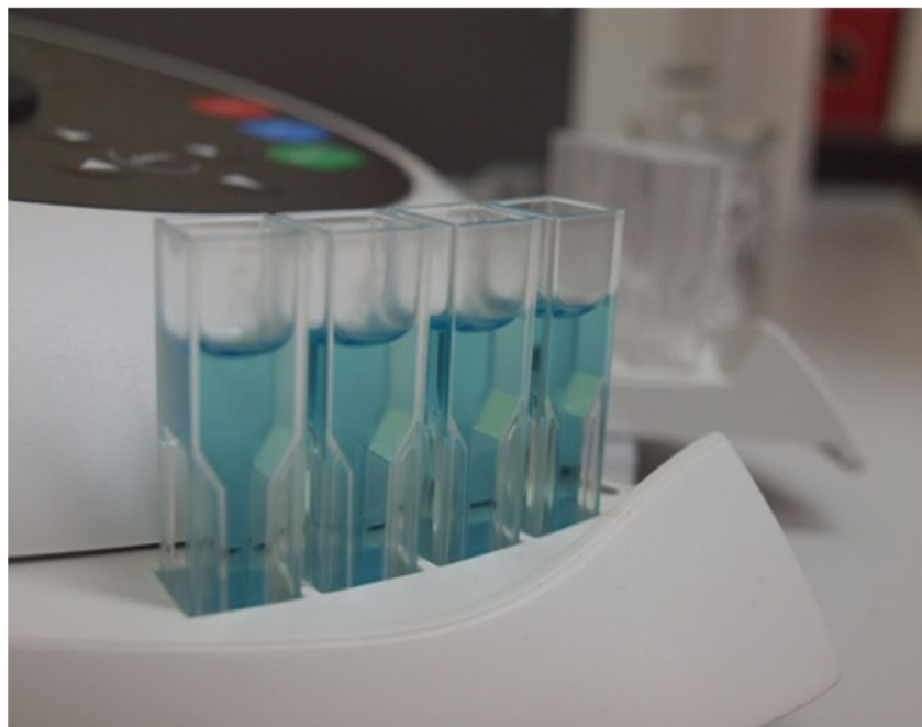
Slika 19. Uzorci pripremljeni za oksidaciju otopine ABTS-a uz otopinu kalijevog persulfata.. Veći antioksidativni kapacitet=manje zeleno obojenje jer se uništava radikal (vlastiti izvor)
