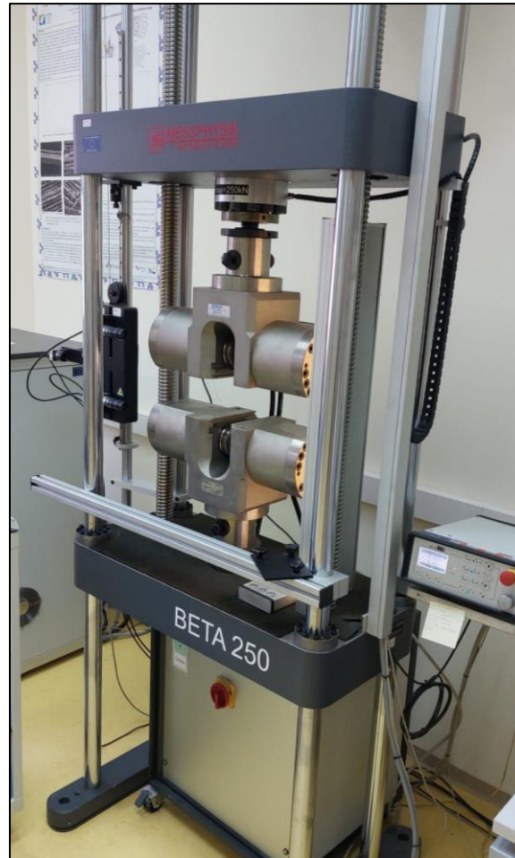
Slika 38. Univerzalna statička kidalica MESSPHYSIK BETA 250 [Izvor: Autor]
