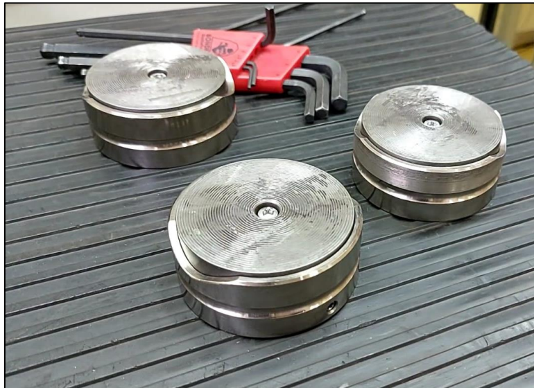
Slika 37. Nastavci za pričvršćivanje epruvete u čeljusti kidalice [Izvor: Autor]
