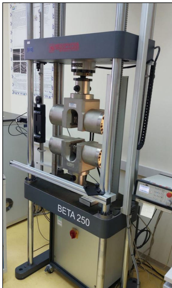
Slika 38. Univerzalna statička kidalica MESSPHYSIK BETA 250 [Izvor: Autor]
