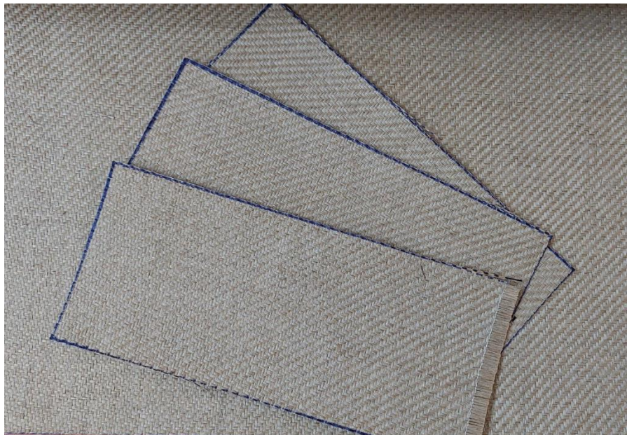
Slika 30. Iskrojeni slojevi vlakana [Izvor: Autor]
