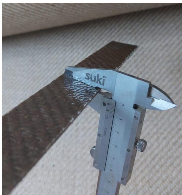
Slika 33. Konačna debljina epruvete [Izvor: Autor]
