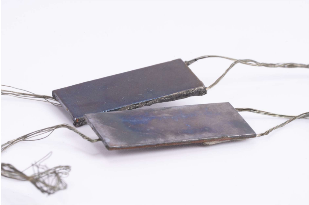
Slika 1. Prva fotonaponska ćelija
