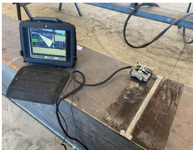
Sl.12 Ispitivanje zavara ultrazvučnom metodom, Izvor: http://pondt.hr/paut-ultrazvucno-ispitivanje-visepretvornickom-tehnikom/ (02.09,2024)
